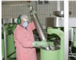
Fig. 1: Extragerea rotorului cu ajutorul unui dispozitiv de ridicare montat în tavan.
