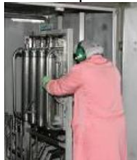
Fig. 2: Transportarea a 8 rotoare cu căruciorul
