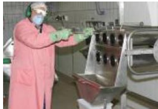
Fig. 3: Scurgerea lichidului din rotoare cu căruciorul înclinabil
